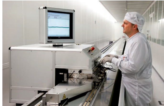
30 m lange Messmaschine für Maßbänder
