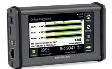
Für den mobilen Einsatz geeignetes Testgerät PWT 101
