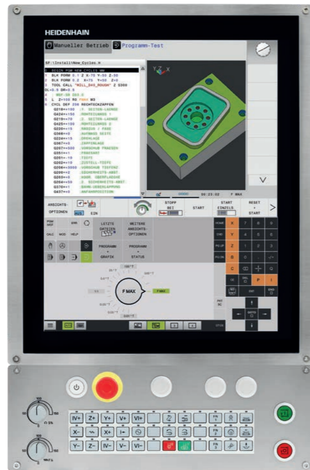
TNC 620 in der Ausführung mit Touchscreen (nur für TNC 620)
